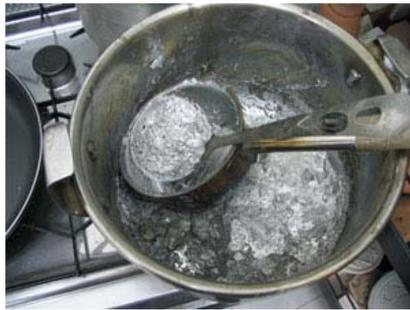
Con una cucina a gas si possono raggiungere i gradi sufficienti per i metalli di bassa temperatura di fusione, ma abbiamo dovuto utilizzare un piccolo bruciatore a gas, di quelli che si usano in idraulica, per potere arrivare alla temperatura necessaria per fondere l'antimonio. Una volta liquefatti i metalli, si agita o si rimesta la miscela fino a che rimanga uniforme e si tolgono le impurità che galleggiano in superficie. In quel momento la lega è già pronta per essere versata nel calco.
