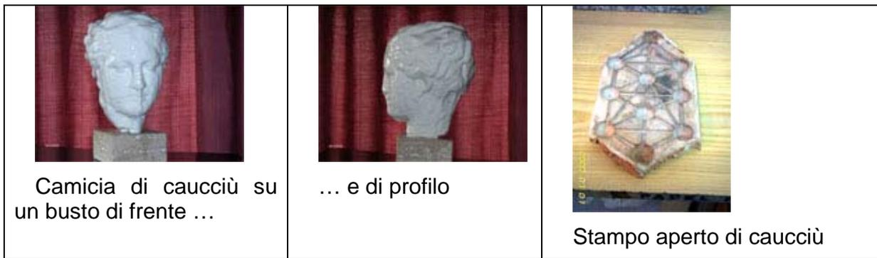
È il materiale idoneo per fare stampi in negativo, e non dovendo essere distrutto per estrarne il pezzo, permette la fabbricazione di figure in serie. Permette inoltre lavori con una risoluzione di grande dettaglio, copiando la benché minima variazione della superficie del pezzo. Cioè, è capace di lasciare il segno nelle copie di dettagli di qualcosa tanto fine come un capello o un granello di sabbia.
