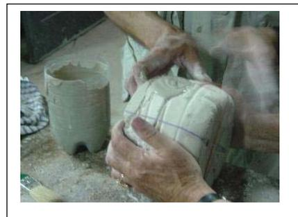
La si lascia asciugare per circa una o due ore (a seconda della temperatura ambiente e di quanto sia secco il gesso), quindi si rovescia il resto della barbotina, rimanendone aderita al gesso uno strato di mezzo cm. di spessore.
