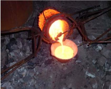
Si è lavorato con peltro, alluminio, alpaca, bronzo e ferro. Per il peltro si usano direttamente stampi di gesso, dato il basso punto di fusione. È importante assicurarsi che lo stampo sia ben secco. Il peltro si può fondere sul fornello della cucina, in un recipiente di acciaio inossidabile.
