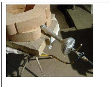
Sulla guaina si colloca un piano di mattoni refrattari (1200°), con un po' di cemento refrattario nelle giunture. In questo caso sono stati usati 10 mattoni.
