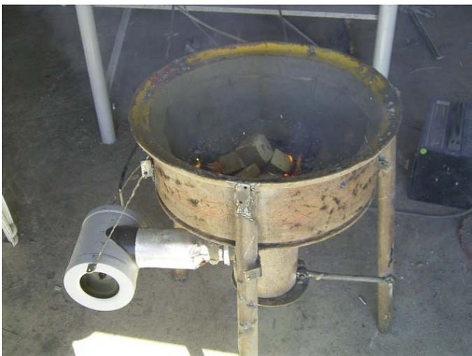
La nostra Forgia è terminata. Alla sinistra il ventilatore (un estrattore da cucina). Si osservi il meccanismo di controllo del flusso dell'aria, che si ottiene aprendo e chiudendo il tappo inferiore del portacenere. Si colloca carbon coke all'interno con alcuni rametti che si accendono. L'aria del ventilatore ravviva il fuoco, che può raggiungere più di 1200° C.
