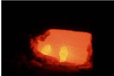
Si spegne il gas, si apre la porta del forno e si lascia raffreddare fino a che la ceramica sia tiepida.
