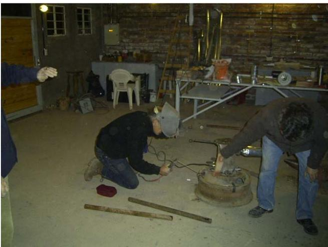
Saldatura delle zampe alla ruota di camion.
