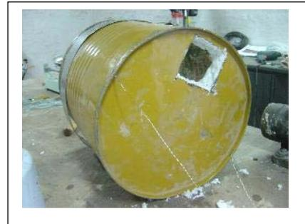
A metà dell'altezza del bidone si fa un foro nella lastra e nella guaina refrattaria per collocare il pirometro.
