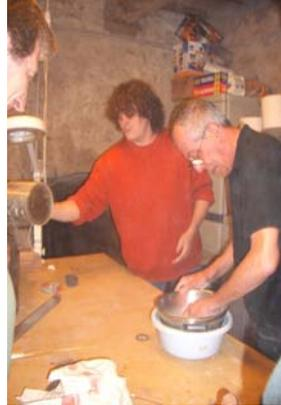
Si mescolano adeguatamente i due componenti e... poi ancora un po'! Si finisce di impastare battendo i blocchi per tirare fuori l'aria.
