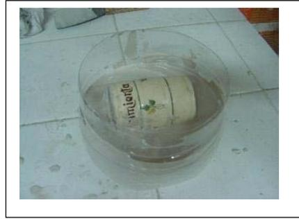
Una volta che si è finito di indurire il gesso, si procede a fare il gesso dell'altra metà, cioè, la metà superiore. Prima di versare il gesso si copre il primo gesso con una pellicola, che mantenga ben separati i due tasselli di gesso per poterli poi separare.
