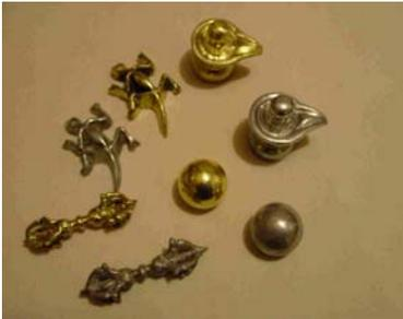
È stato usato bronzo di differenti qualità, senza saperne la lega esatta. Fonde da 1200° a 1280° gradi centigradi. Le prime fusioni sono state realizzate in forno con isolamento di guaina ceramica ed un bruciatore a gas butano. È stato usato un crogiolo di carburo di silicio con una capacità di circa 15 kg. Poi si è continuato a fondere nel forno a carbon coke e nella forgia..
