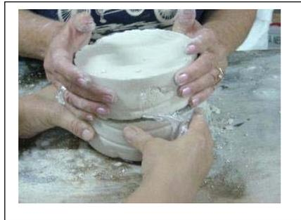
Induritosi l'ultimo gesso, si tolgono con cura i due tasselli di gesso (separati dalla pellicola), separandoli dall'originale. Nel gesso c'è la serratura fatta (nel secondo gesso appare il positivo della serratura).
