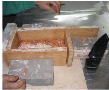
Se l'originale ha qualche cavità bisogna riempirla per non avere difficoltà nell'estrazione del positivo. Non dovrebbero generare concavità nello stampo neanche spigoli e bordi, tutti dettagli che si possono poi intagliare e profilare a punzone una volta che il pezzo sia asciugato e si estragga dal negativo.
