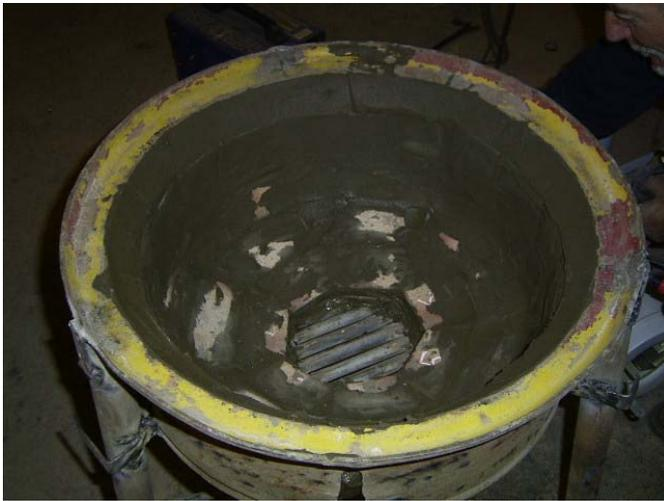
Pezzi di mattoni refrattari incollati con cemento speciale all'interno della forgia. Notare le barrette di acciaio al centro, per permettere l'entrata dell'aria e per impedire che le ceneri ostruiscano il portacenere.
