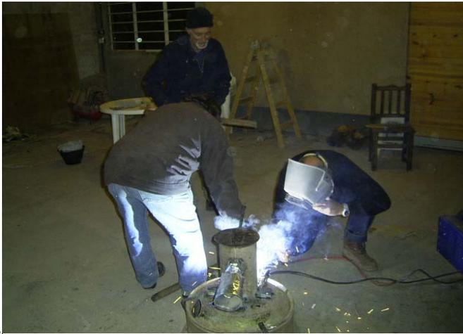
Saldatura del portacenere, cioè il tubo inferiore attraverso cui entra l'aria, che permette che le ceneri non ostruiscano i fori di entrata.
