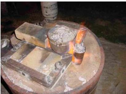
Peltro e alluminio raggiungono la fusione nella bocca del forno. È stato usato quello in barre con leghe di fabbrica. Temperatura approssimativa di fusione 800 gradi centigrai..
