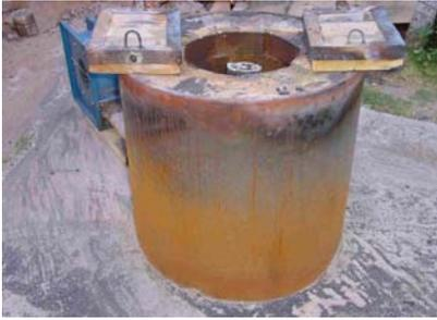
La costruzione del forno per fondere bronzo è stata fatta con mattoni refrattari (con entrata laterale per il bruciatore a gas). L'esterno è stato ricoperto di guaina ceramica ed acciaio.
