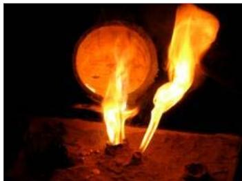
11. Si aspetta un poco e si immergono completamente in un bidone con acqua fino a farli raffreddare. Con un martello si rompe il guscio di ceramica.
