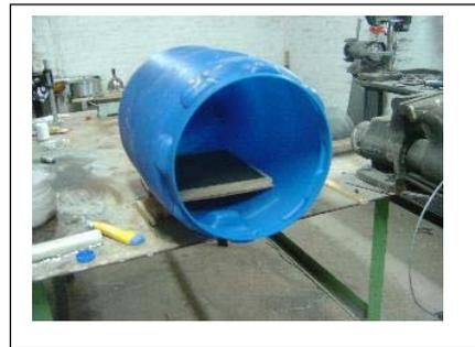
Si procede a chiudere la camera assicurandola con la ghiera. Alla valvola di gonfiaggio si avvita il tubo del gas e lo si immette finché non si gonfia il coperchio (aprire e chiudere il gas).
